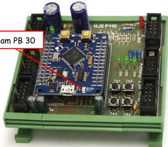
Der Nano SAM D21 wird mit einer Spannung von +5V versorgt. Auf dem Modul befindet sich Spannungsregler für +3,3V. Alle Ein- und Ausgänge dürfen nur mit einer **maximalen** Spannung von **+3,3V** betrieben oder angesteuert werden. Jede höhere Spannung kann zu einer sofortigen **Zerstörung** des Moduls führen.
