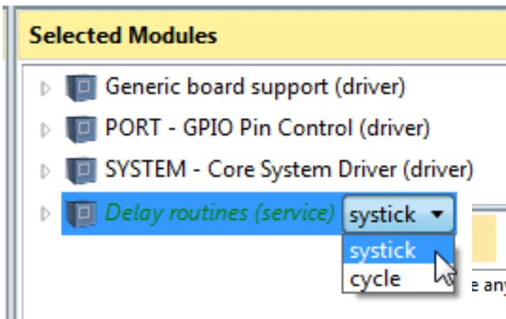
Bei der Auswahl von **systick** muss im Programm (**main**) einmal **delay\_init()** aufrufen werden.
