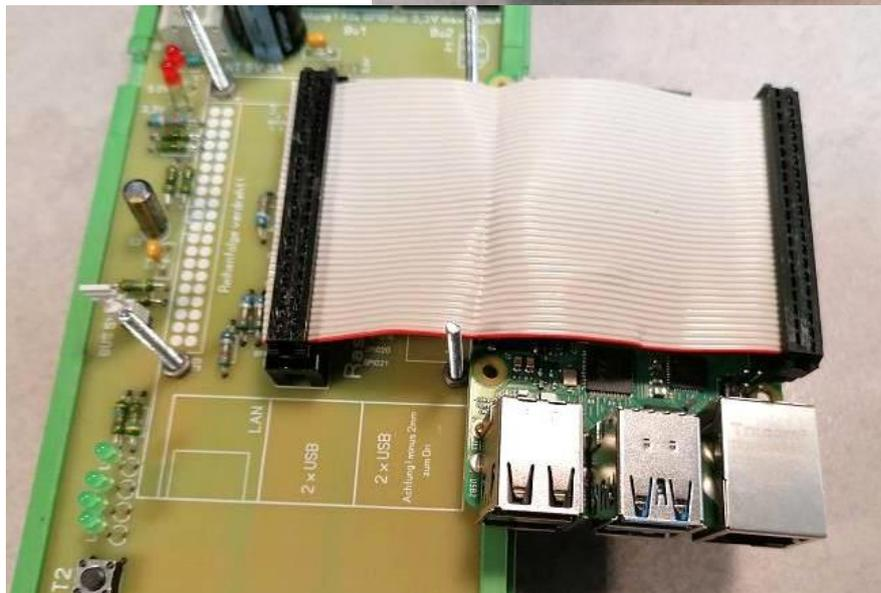
Ansicht der Grundplatine mit Verbindungskabel und Raspberry
