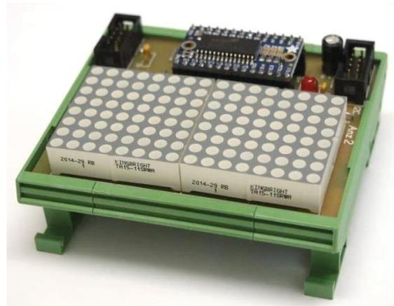
Damit bestehen die 2 Matrix Anzeigen insgesamt aus 16 Zeilen. Gezählt wird von 0 bis 15 und entspricht damit 16 Zeilen.
