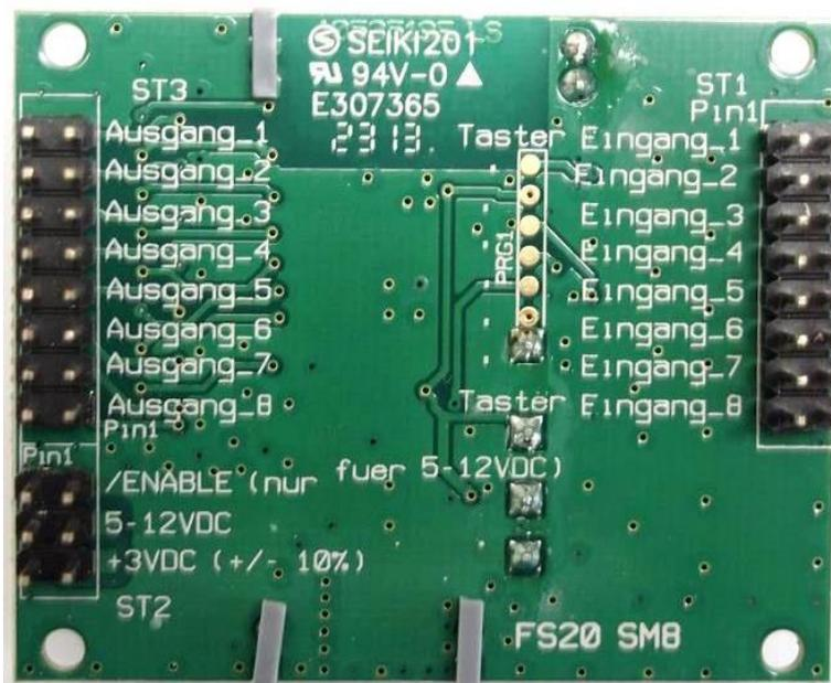
Auf der Rückseite befindet sich noch einmal eine genaue Belegung der einzelnen Kontakte. Die einzelnen Ein- und Ausgänge sind jeweils auf 2 pol. Stiftleisten im RM 2,54 geführt. Der genaue Aufbau geht aus der Montageanleitung und dem Schaltbild des Herstellers hervor. Mit dem Jumper erfolgt die Umschaltung **Einzelmodus** (Jumper geschlossen) oder **Normal** (Jumper offen)
