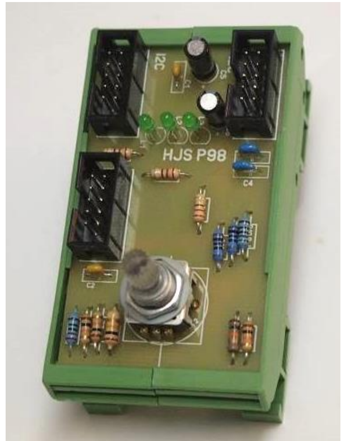
Encoder mit RGB LED auf P98 und Wannenstecker
