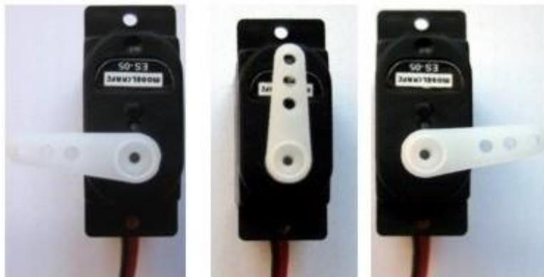
In Abhängigkeit einer Impulslänge wird die Position eines Servos gezeigt. Dabei entstehen 3 Stellungen:
