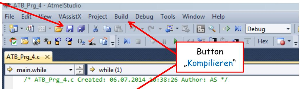
Nach dem ich „Build“ betätigt habe, erscheint diese Bild. Mit „Build ATB\_Prg\_4“ wird das angezeigte Programm kompiliert.
