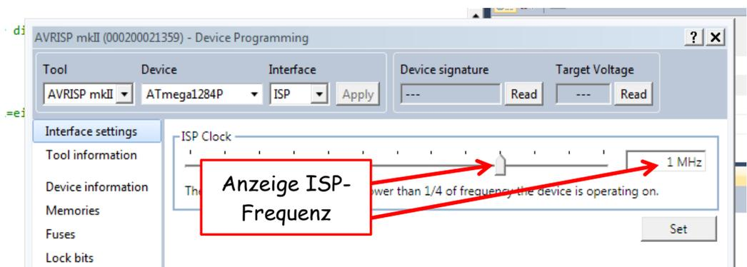
Im Auslieferungszustand ist der ATmega 1284p mit dem **internen Oszillator 1 MHz** programmiert. Da die ISP-Frequenz max.  $\frac{1}{4}$  der Oszillator Frequenz betragen darf, kann die Signatur nicht ausgelesen werden. Im Feld „Device signature“ kann dadurch nichts angezeigt werden.
