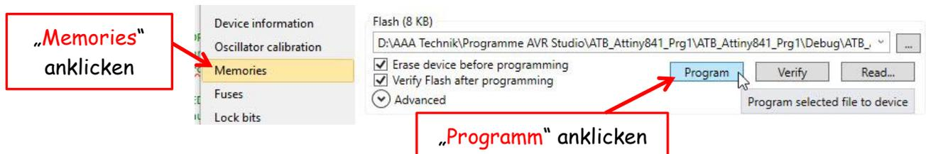
Als letzten wird das Programm auf unseren Prozessor übertragen. Dazu bitte „Memories“ anklicken. Das korrekte Programm müsste bereits angezeigt werden. Danach noch „Programm“ anklicken und unser Programm wird auf den Attiny 841 übertragen.
