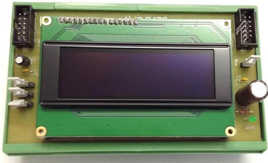
Das Display W204-XLG ist für den direkten Betrieb am I<sup>2</sup>C Bus nicht vorgesehen. Der Betrieb erfolgt deshalb mit einem PCF8574 mit 4 Bit.
