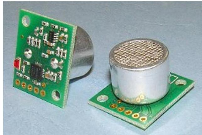
Wie ihr sehen könnt erfolgt der Anschluss an den 5 Kontakten an der Unterseite. Das kann mit Steckkontakten oder Flachkabel erfolgen. Zusätzlich gibt es zwei Befestigungslöcher mit deren Hilfe eine feste Montage an einer Wand oder Halterung erfolgen kann.
