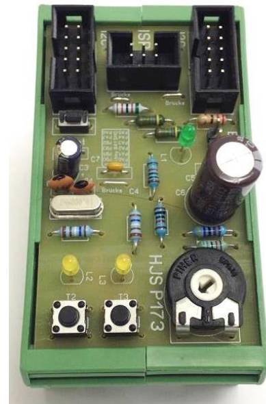
Schaltung P173 mit Attiny 841 mit Quarz, 2 Taster, 2 LEDs, Poti und Ansicht Platine
