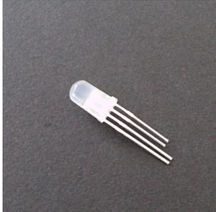
LEDs mit dem P9823 Controller IC gibts in THT Versionen 5mm und 8mm aber auch in mehreren SMD Gehäuseformen.
