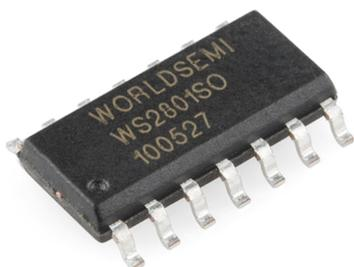
Die **WS2801 IC** sind die erste Generation von Steuer-IC für LED Pixel der WS28xx Familie von **World Semiconductor** und die einzige die mit einem separaten Taktleitung arbeitet. Deshalb muss der Anschluss mit 2 Datenleitungen erfolgen, **Takt** und **Daten**. Andererseits erlaubt gerade dies eine relativ zeitunkritische Ansteuerung mit sehr einfachen Mitteln und beinahe jedem beliebigen Mikrokontroller.
